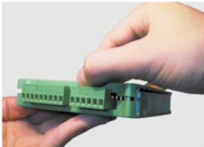
Gehäuse schließen. Fermeture du boîtier.
