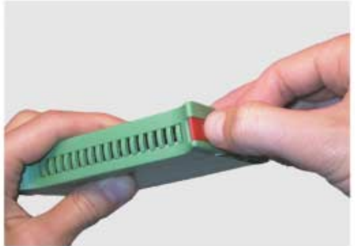
Demontage des Rasthakens: Anmerkung: auf das Gehäuseunterteil drücken und den Rasthaken herausziehen. Démontage du crochet: remarque: appuyer sur la base du boîtier et faire glisser le crochet hors de son emplacement.
