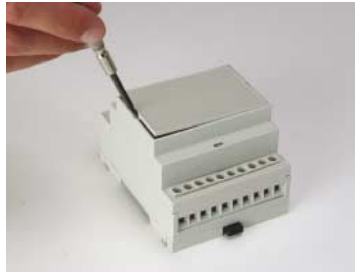
Frontplatte entfernen Enlever le panneau
