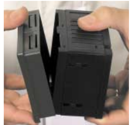
Die Leiterplatten durch die Montage des Vorderrahmens befestigen Fixer les circuits imprimés en montant le cadre antérieur
