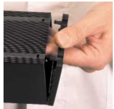
Leiterplatte durch Montage des hinteren Rahmens befestigen. Fixer le circuit imprimé en montant le cadre postérieur.
